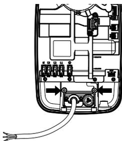
Utilice los 2 tornillos M6x14 (par de apriete de 1,2 Nm) suministrados para fijar la unidad de carga al soporte de pared a través de los
