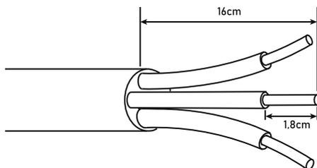
1. Longitud de  $\pm 16$  cm desde el revestimiento aislante exterior del cable de alimentación. Considere la posibilidad de acortar la longitud del cable si ello facilita la instalación.
