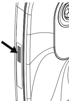
La pantalla MID introduce el modo stand-by tras 1 minuto. Para reactivarlo, active el sensor de movimiento moviendo la mano cerca de la pantalla.
